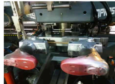
Ripeto produttiva. Stampi per la produzione di scarponi da sci.
