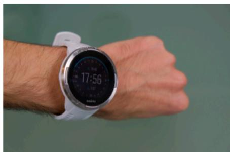
Il **Suunto 9 Baro** è resistente all'**acqua** fino ad una profondità massima di **10 metri**, può essere utilizzato in un range di temperatura oscillante tra i **-30** ed i **+55 gradi** centigradi, nonché connettersi allo smartphone tramite il **bluetooth**.
