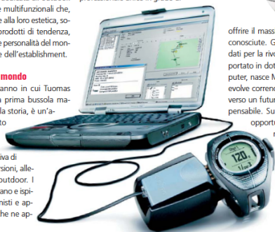
A sinistra, il modello Suunto G9 (2003) per golfisti, con cronografo multifunzione, termometro, altimetro, bussola 3D, collegato al computer. Foto: Courtesy Suunto.
