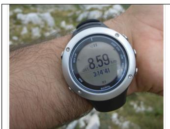
nel caso di sport multipli ovvero passando dalla corsa alla bicicletta, il dispositivo si accorge immediatamente che l'accelerazione del polso non sta dando dati di velocità corretti e quindi disattiva FusedSpeed continuando a registrare il puro dato di velocità proveniente dal GPS o dal sensore di velocità/cadenza. (La funzione FusedSpeed viene attivata solo con i seguenti sport: trail, running, triathlon, corsa, calcio, orienteering, multisport, football, football americano.)
