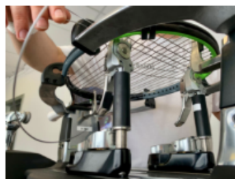
Vista dal basso delle pinze della macchina incordatrice che bloccano le corde nel montaggio
