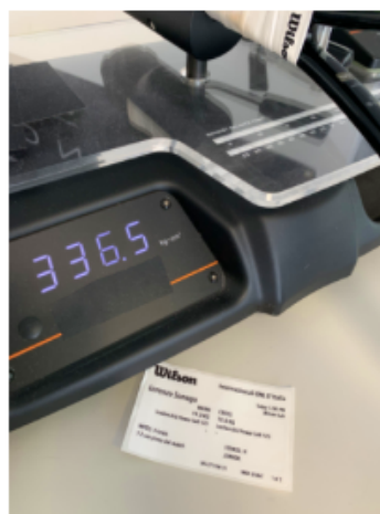
Il dato dell'inerzia della racchetta di Sonego è di 336,5 kg per cm2
